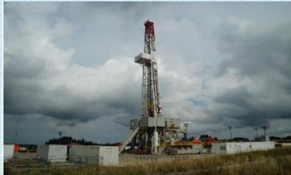
La perforación de pozos geotérmicos es la obra principal y necesaria para realizar los estudios geocientíficos del subsuelo y determinar la existencia de un reservorio geotérmico en el área de interés volcán Cosiguina.
